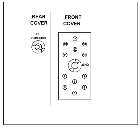
Figure 5 - UDC Pin-Out
